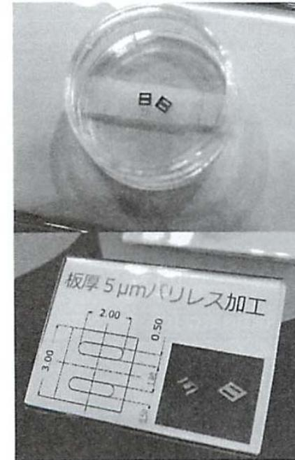
(株)JKBは、板厚5 $\mu$ mの箔材の微細プレス加工品を披露した。ステンレスの箔材を抜き加工したあとコの字型に90°曲げたもの。抜き加工ではバリレスが前提となるほか、曲げ加工では材料を5 $\mu$ mまで薄くするために圧延を繰り返しているためスプリングバックもでやすく難度が高いという。もともとはレーザー加工で作っていた製品をプレス加工に工法転換したものの。
